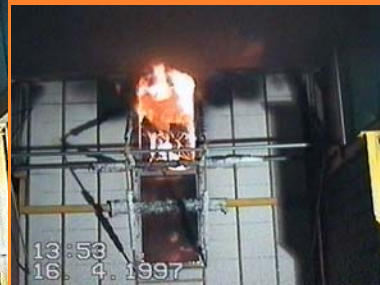
Außenfassade: Zerstörung der oberen ESG-Scheibe nach 5 min 53 s, Flammen oberhalb der Fassadenoberkante
