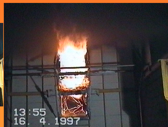
Außenfassade: Zerstörung der unteren ESG-Scheibe nach 7 min 50 s
