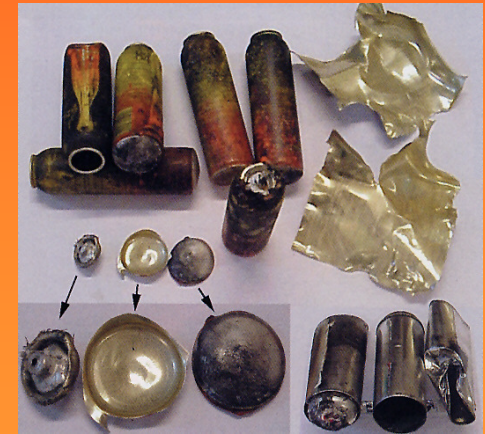
Schadensbilder bei den Druckgaspackungen
