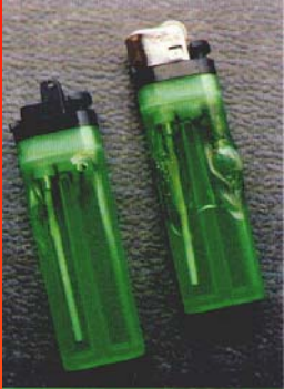
Geschädigte Feuerzeuge mit Blasen und Löchern
