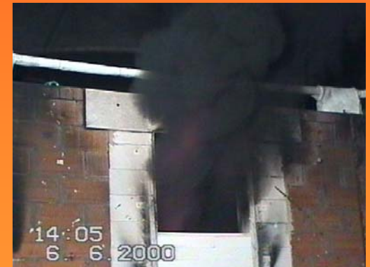
12 min 58 s (nach Zündung) an der Fensteröffnung Flashover
