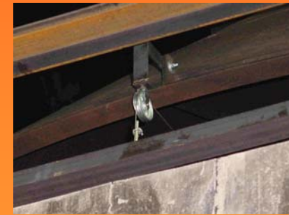
Messung der Durchbiegung von Stahlträger 1
