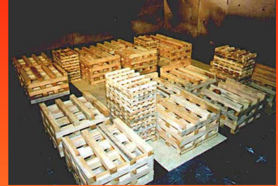
Brandlast: ca. 336 kg (Holzkrippen: ca. 314 kg, Linoleum: ca. 19 kg, Nadelfilzteppichboden: ca. 2 kg, Heptan: 1 l)
