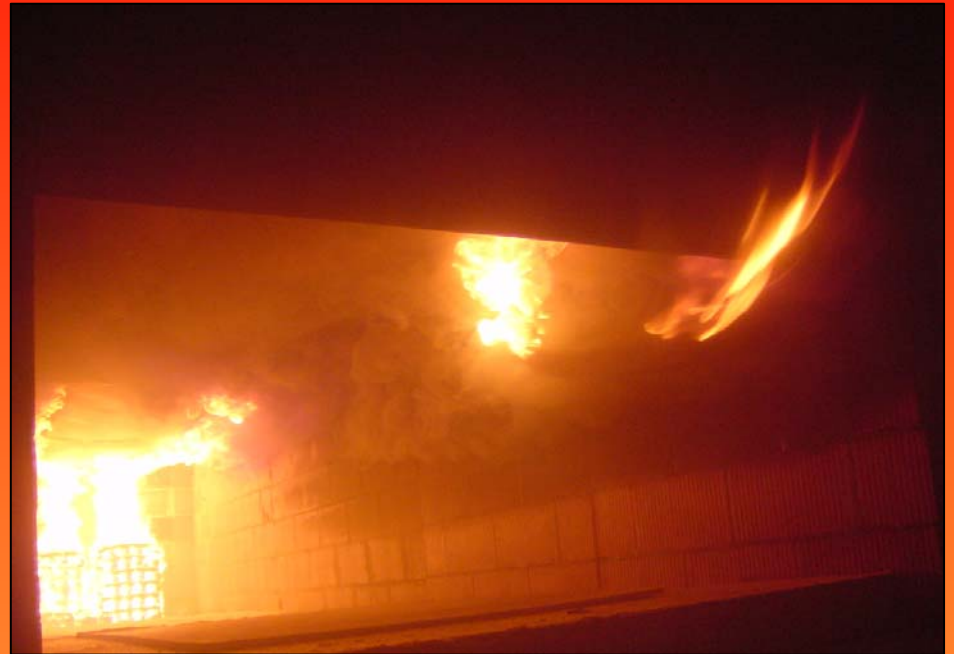
Rollover während eines Brandversuches an einem Industrieleichtdach an der FFB
