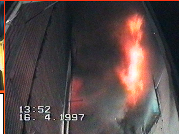
Zwischenfassadenbereich: direkte Beflammung der Außenfassade, Entzündung unverbrannter Rauchgase bei ca. 3 - 4 min
