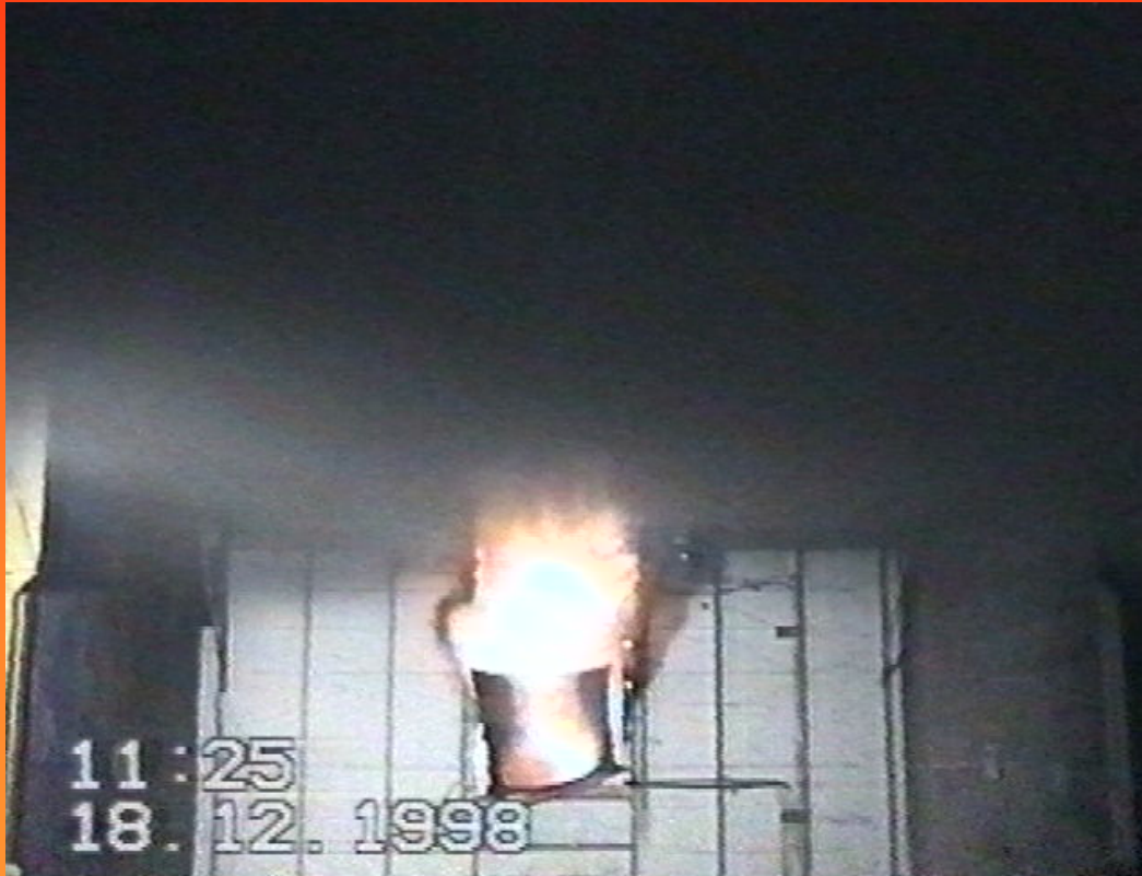
Außenfassade: ESG-Scheibe hat während der Brandbelastung ihre Vorspannung verloren und fällt vollständig aus dem Aluminiumprofilsystem
