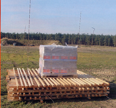
Palette mit 30 Kisten à 60 Dosen mit Deo-Spray (Aluminium 150 ml) auf Holzstapel (Versuch 1)
