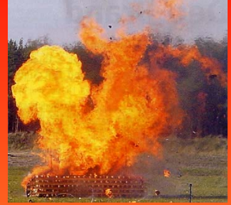
Vollständige Flammeneinhüllung, Bersten erster Dosen nach 1 min 15 s
