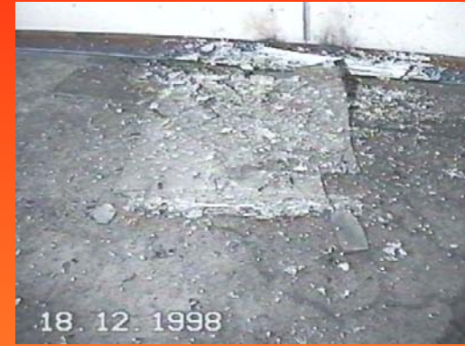
ESG-Scheibe (nach der Brandbelastung ohne Vorspannung) zerspringt auf dem Boden in große Stücke
