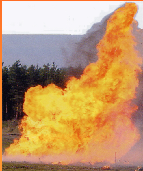
Brandentwicklung 2 min nach Zündung (Feuerballdurchmesser max. 10 m)
