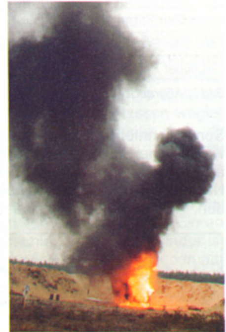
5 min: Stichflammen und starke Rauchentwicklung beim Abbrand der 24.000 Feuerzeuge
